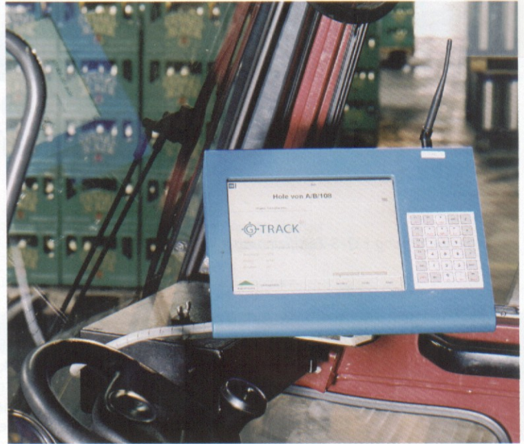
Beleglose Kommissionierung/Staplersteuerung z.B. G-Track (Locanis) (alle Fotos: Schulte Bender & Partner)
