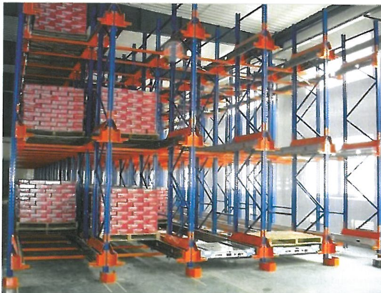
Bild 1: Für Einweg oder nicht stapelbare Paletten können Lagerbereiche mit Einfahrregalen definiert werden.
