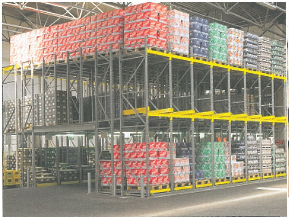
Kommissioniertunnel inkl. Reserveebenen (Quelle:SSI Schäfer)
